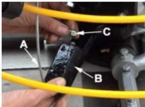
**УРОВЕНЬ МАСЛА И СМАЗКА.** Проверьте уровень масла в двигателе и редукторе. Гарантия на двигатель и затирочную машину **НЕ ПРЕДОСТАВЛЯЕТСЯ** в случае эксплуатации устройства без масла. Лезвия смазаны.
