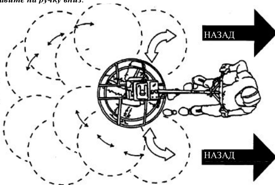
Лучший метод отделки бетона – медленно отступать с машиной **назад**, направляя ее из стороны в сторону. Тем самым вы захватите все отпечатки на мокром бетоне.
